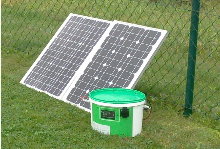
Abbildung 4.2.: Weitere Möglichkeit einer Solarzellenanbindung, hier die Nutzung des *I-Mehr* als Stromversorgung im Garten z.B. als Baustromversorgung oder für eine Gartenfeier.
